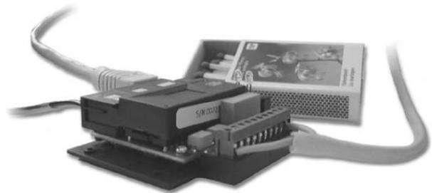
Figure 2. SSL/TLS-enabled mini Web server
